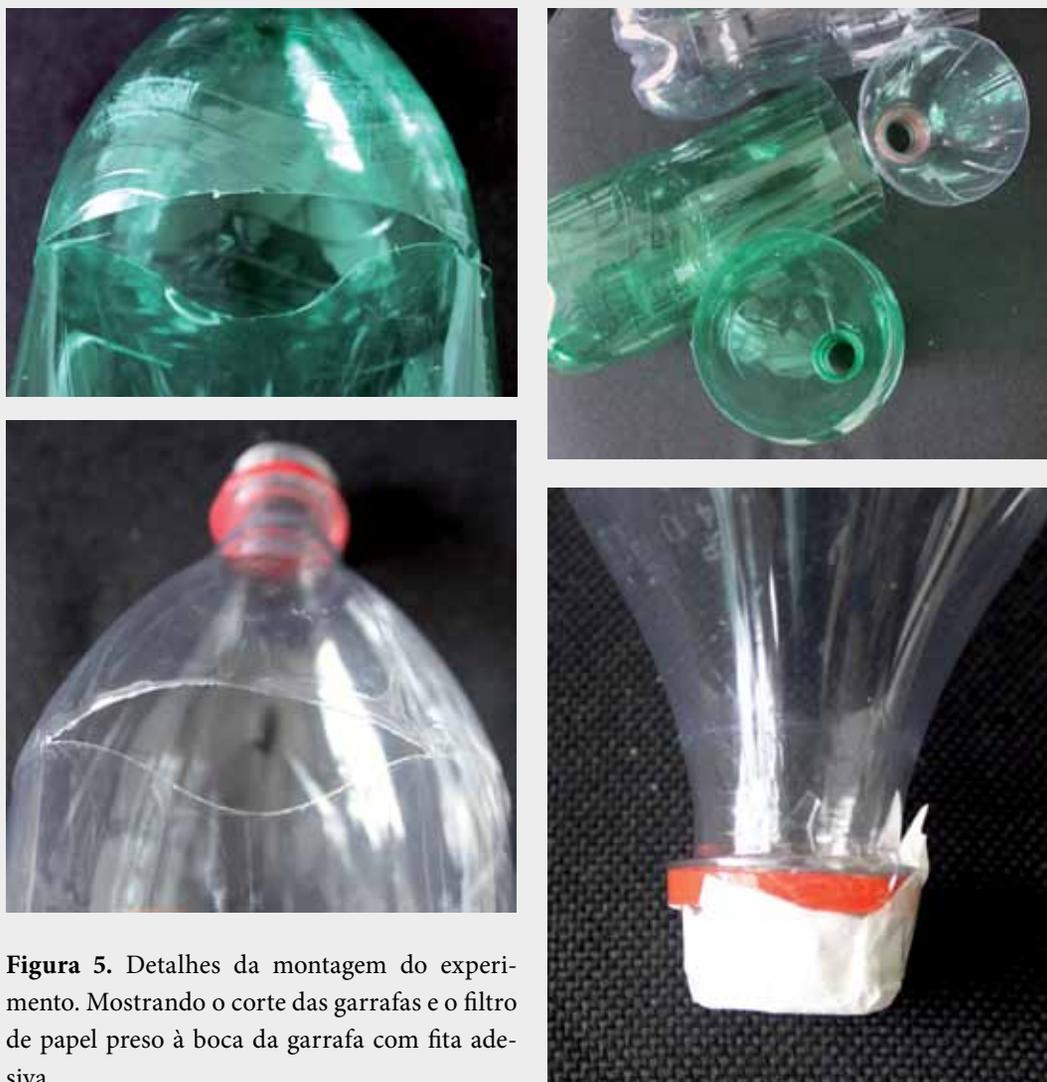
**Figura 5.** Detalhes da montagem do experimento. Mostrando o corte das garrafas e o filtro de papel preso à boca da garrafa com fita adesiva.
