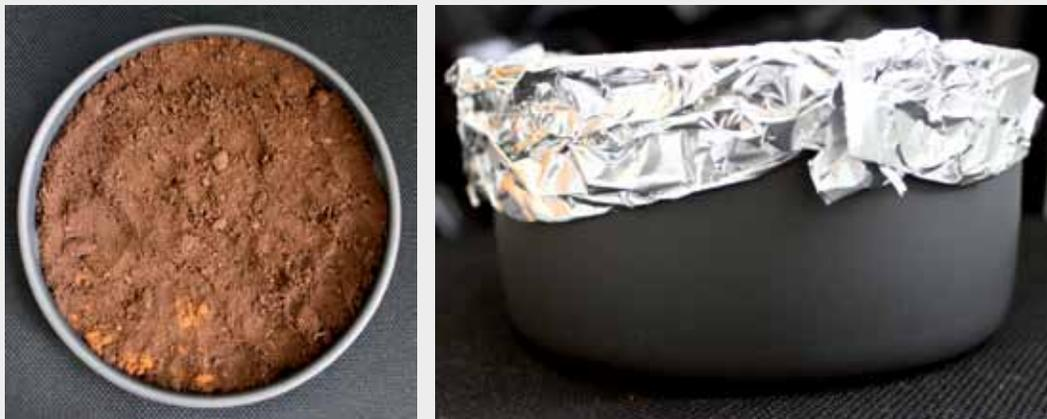
**Figura 8:** Forma metálica com terra vegetal e posteriormente coberta com papel alumínio para ser levada ao forno.
